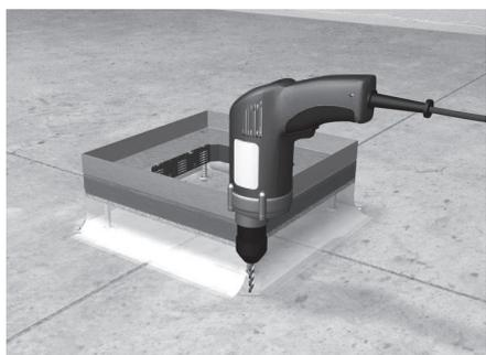
Fixe a caixa no chão. Assegure-se que a membrana está do lado exterior da caixa ajuste a altura e nivelamento da caixa através dos 4 parafusos que se encontram nas extremidades.
