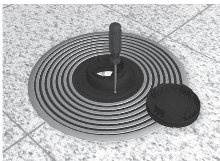
Fixe os dois parafusos do tubo à tampa e cubra a unidade de alimentação. Ao apertar estes parafusos o tubo fica protegido contra forças laterais e permanece sempre na posição.
