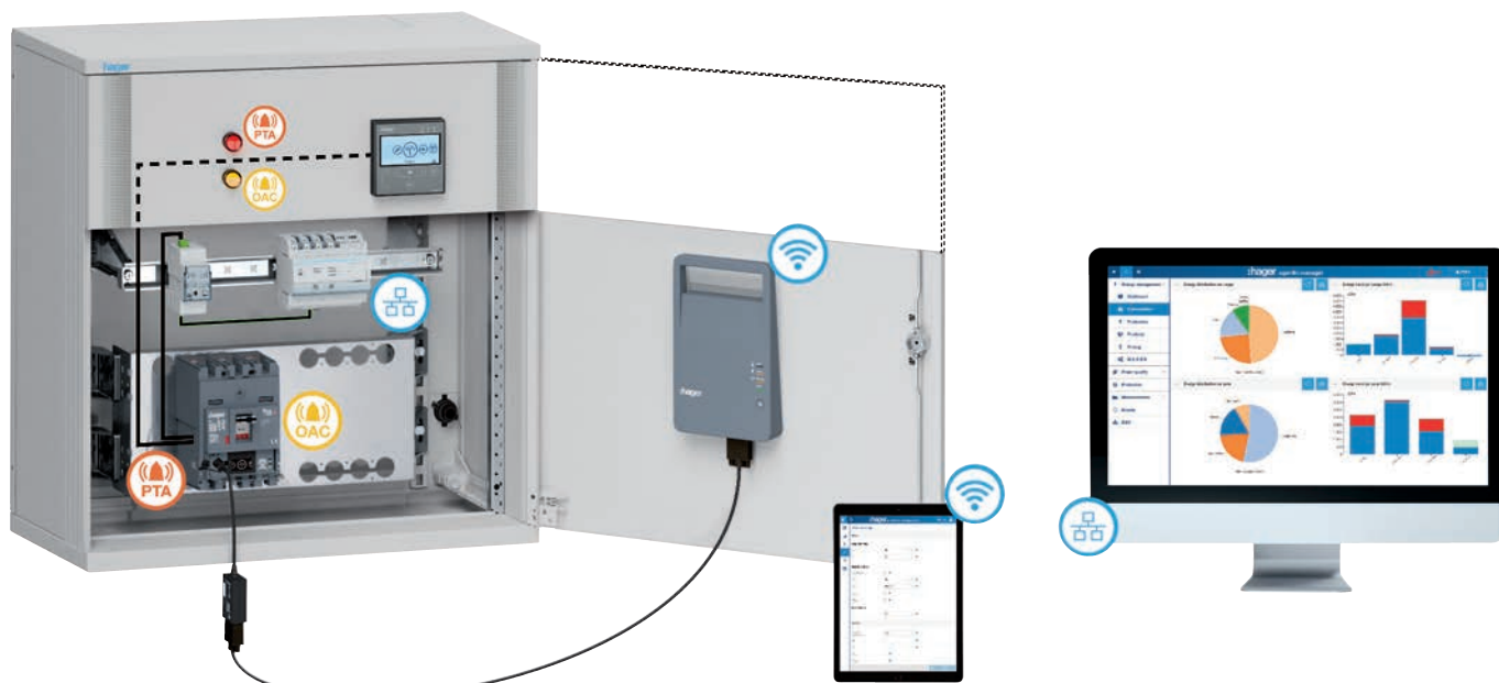
h3+ communicatie schematisch
