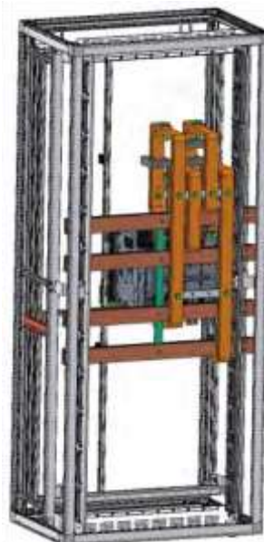
Aansluiting ACB op FST
