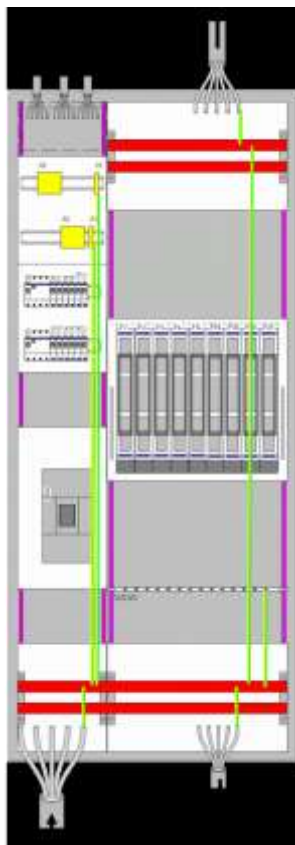
Extra beschermingsleidingrail I_{NA} 630 A
