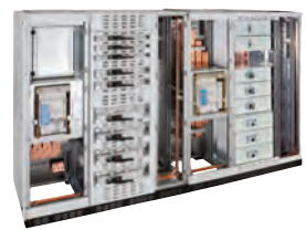
verdeelsysteem Unimes diepte 600 / 800 mm bouwvorm 1 t/m 4b max. 6300 A IP40 plaatstaal
