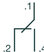
Aansluiting en functie van een alarmcontact
