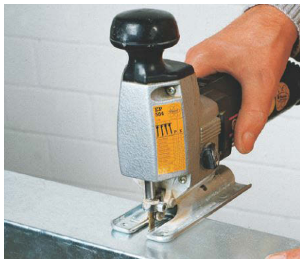
De FWK kanalen laten zich met een decoupeerzaag gemakkelijk op maat maken.
