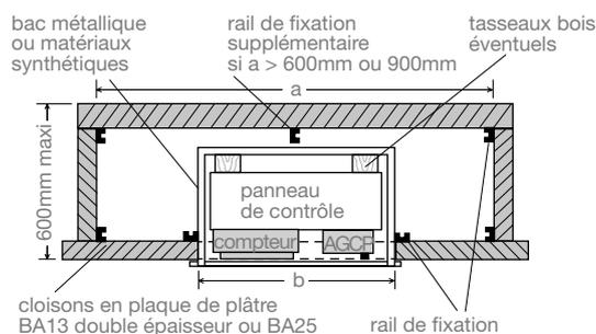
Lorsque le bac d'encastrement à une largeur supérieure ou égale à 600 mm (b), il convient que la côte (a) soit supérieure à la côte (b) et qu'un rail supplémentaire soit installé pour rigidifier la cloison. Lorsque des plaques de plâtre BA 25 sont mises en œuvre, un rail supplémentaire est à ajouter que si la côte (a) est supérieure à 900 mm.
