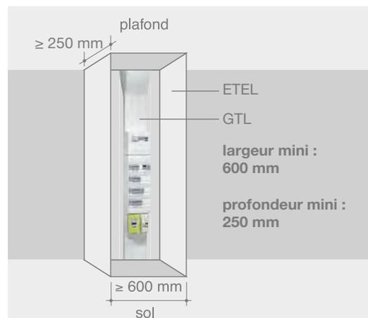
Remarque : après l'installation, la largeur de l'ETEL peut être limitée à la largeur de la GTL plus 100 mm.
