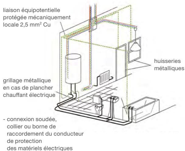
La réalisation de la liaison équipotentielle supplémentaire peut également être faite en "bus".
