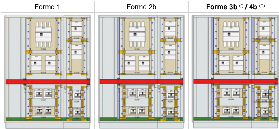
(*) Forme 3b (compartiment de gauche) (**) Forme 4b (compartiment de droite)
