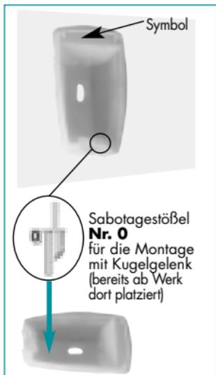
**!** Bei flacher oder abgewinkelter Montage des Bewegungsmelders an einer Wand oder Mauer das oben abgebildete Etikett (im Zubehör enthalten) auf die Rückseite des Geräts kleben, um die Öffnung abzudecken und das Eindringen von Insekten zu verhindern.
