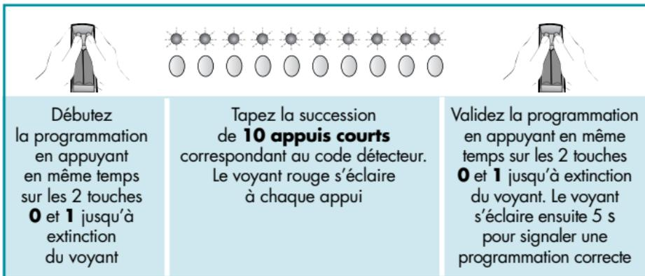
⚠ Si au cours de la manipulation vous attendez plus de 7 secondes entre 2 appuis, si l'appui sur 0 et 1 en début ou en fin de programmation n'est pas simultané ou assez long, vous sortez alors du mode programmation : le voyant clignote, la programmation est incorrecte. Le code initialement programmé est conservé. Recommez l'opération depuis le début.
