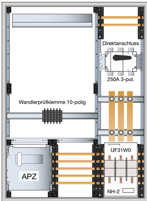
Beistellung der Zählerwechselplatte
