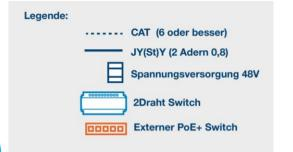
Von einem JY(St)Y werden je ein Adernpaar für den Anschluss an ein 2Draht Systemgerät verwendet.
