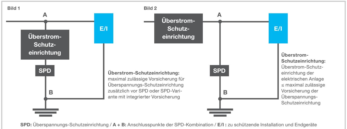
Bei der Installation einer Überspannungs-Schutzeinrichtung in einem Verteiler sollten alle Anschluss- und Verbindungsleitungen generell immer
