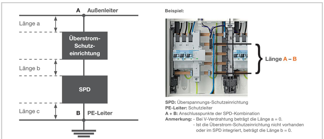
Im Einspeisebereich von Energieverteilungen bieten sich die Ableiter der Serie SPA180 an, diese haben bereits eine integrierte Vorsicherung. Dadurch reduziert sich die Länge b auf null. Befinden sich innerhalb eines Verteilers in der Nähe der Überspannungs-Schutzeinrichtungen Metallteile wie beispielsweise Montageplatten, Traggerüste oder ähnliche
