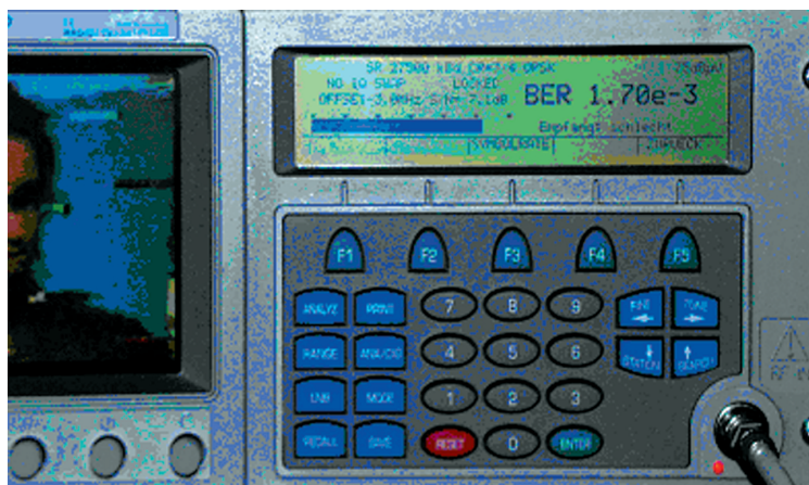
Abb. 12.7 Auswertung des Empfangspegels und der Bitfehlerrate (BER) „Bit-Error-Rate“ (engl.) mit einem Satellitenmessempfänger (hier ein Beispiel für schlechten Empfang)
