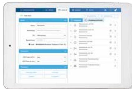
Bei der Inbetriebnahme einer easy-Installation mit funk- und kabelgebundenen Komponenten unterstützt Sie easy in Hager Pilot. Über eine automatische Gerätesuche werden alle kompatiblen Geräte erkannt und die verfügbaren Ein- und Ausgänge vorkonfiguriert. Erforderliche Gerätedefinitionen lädt das Tool automatisch herunter. Anschließend können Sie alle Geräte und Kanäle benennen und parametrieren. Auch die Zuordnung zu einzelnen Bereichen oder Räumen ist direkt möglich.
