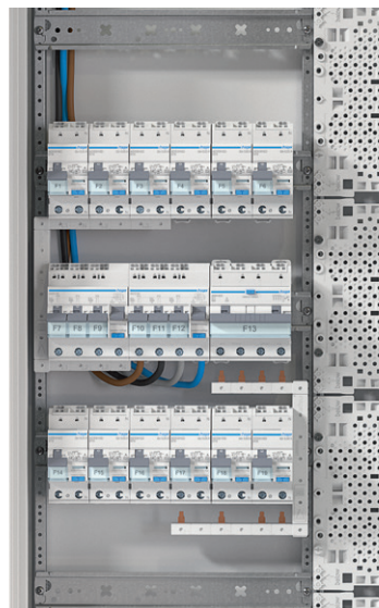
02 Hauptinspei- sung installieren. Senkrechte Phasenschienen Bi-Connect- Klemme der entsprechenden Geräte öffnen, einstecken, anschrauben – fertig!
