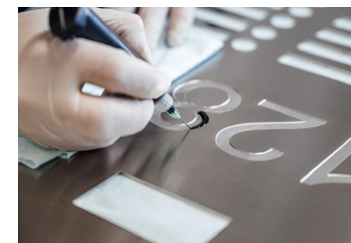
Auslegen der Gravur mit Druck- spritze
