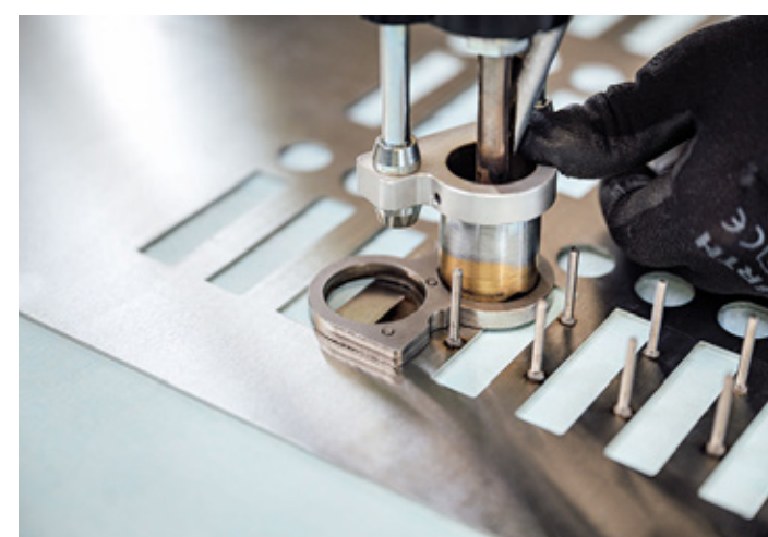
Bolzenschweisspistole mit automati- scher Bolzenzufuhr eingesetzt in Steh- bolzenlehre. Fügestelle wird durch Hitze geschmolzen, dadurch wird der Stehbolzen mit der Frontblende ver- bunden
