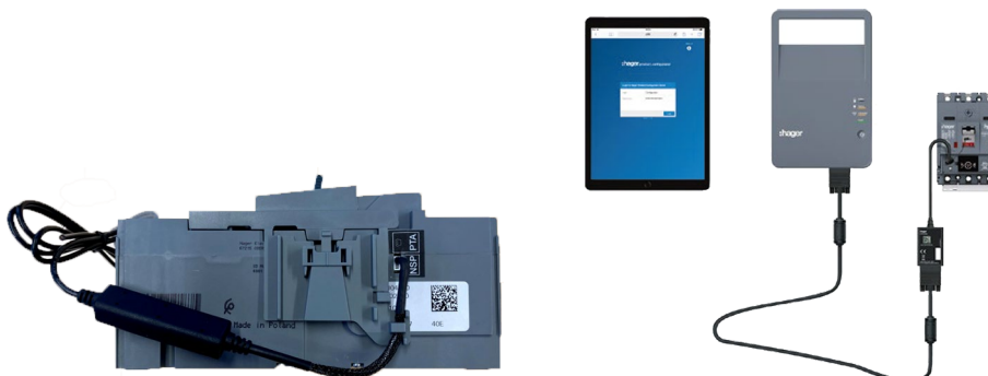
NSP Adapter-Kabel am NSP-Anschluss h3+ Energy MCCB
