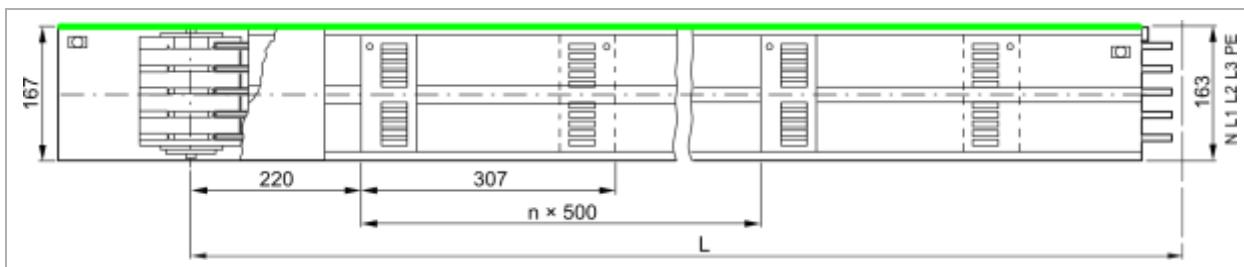
Maßbild für KEM3xS00ZxLMF, Abgangsstellenabstand = 0,5 m
