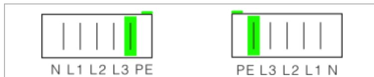
Einbaulage: Gehäuse Flachlage, Leiter hochkant
