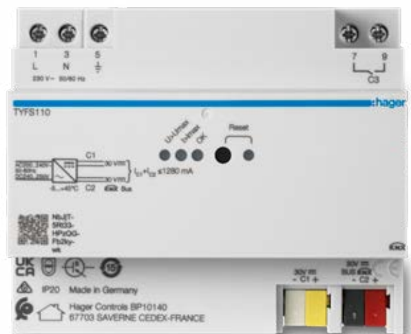
Hager Spannungsversorgung KNX mit 2 Ausgängen inkl. 1 Drossel, 30 V DC 1280 mA Artikel-Nr.: TYFS110, E-N°: 405 800 636
