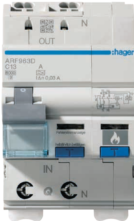
Brandschutzschalter AFDD in Kombination mit Fehlerstrom-Leitungsschutzschalter AFDD FI-LS 1P+N C13 6 kA 30 mA, Best.-Nr. ARF963D, E-No: 805 159 284
