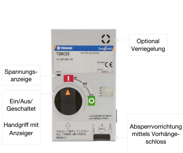
Motorantrieb für 125 A und 250 A Leistungsschalter
