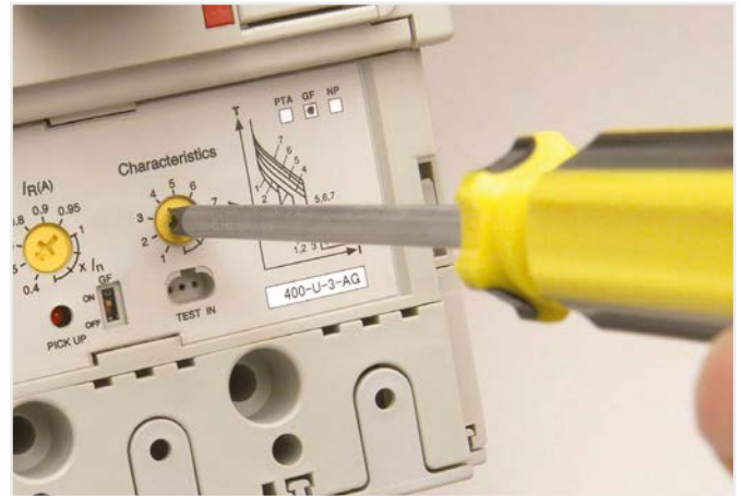
Auswahl einer voreingestellten Charakteristik bei einem TemBreak2, 400 A mit elektronischem Schutz.
