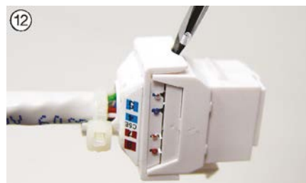
12 Einsatz und Haube mittels Schraubenzieher trennen.
