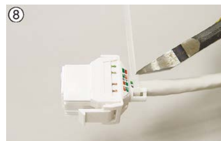
Zwecks Zugentlastung den Kabelbinder durch die Öffnung ziehen und um das Kabel schlau-fen. Kabel beim Anziehen nicht zer-drücken.
