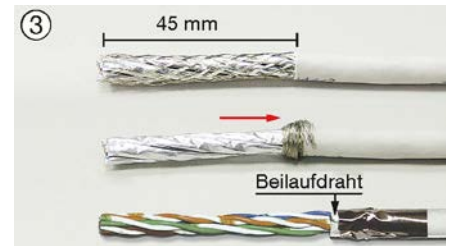
Vorbereitung Datenkabel STP Kabel 45 mm abmanteln. Schirmgeflecht zurückrollen. Bei F/UTP Kabelfolie entfernen. Beilaufdraht auf Mantel legen und Kupferband umwickeln.
