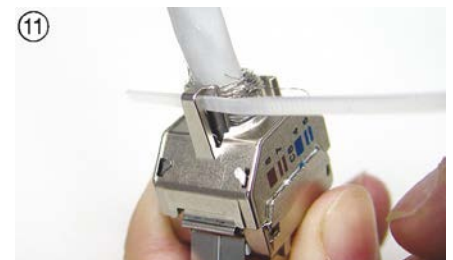
11 Den Kabelbinder durch die Öffnung ziehen und um das Kabel schlaufen. Kabel beim Anziehen nicht zerdrücken.
