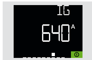
Einstellung des Erdschlussschutz-Schwellenwerts.
