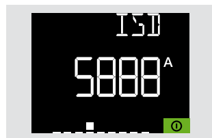
Einstellung des Kurzzeitverzögerungs Grenzwerts.
