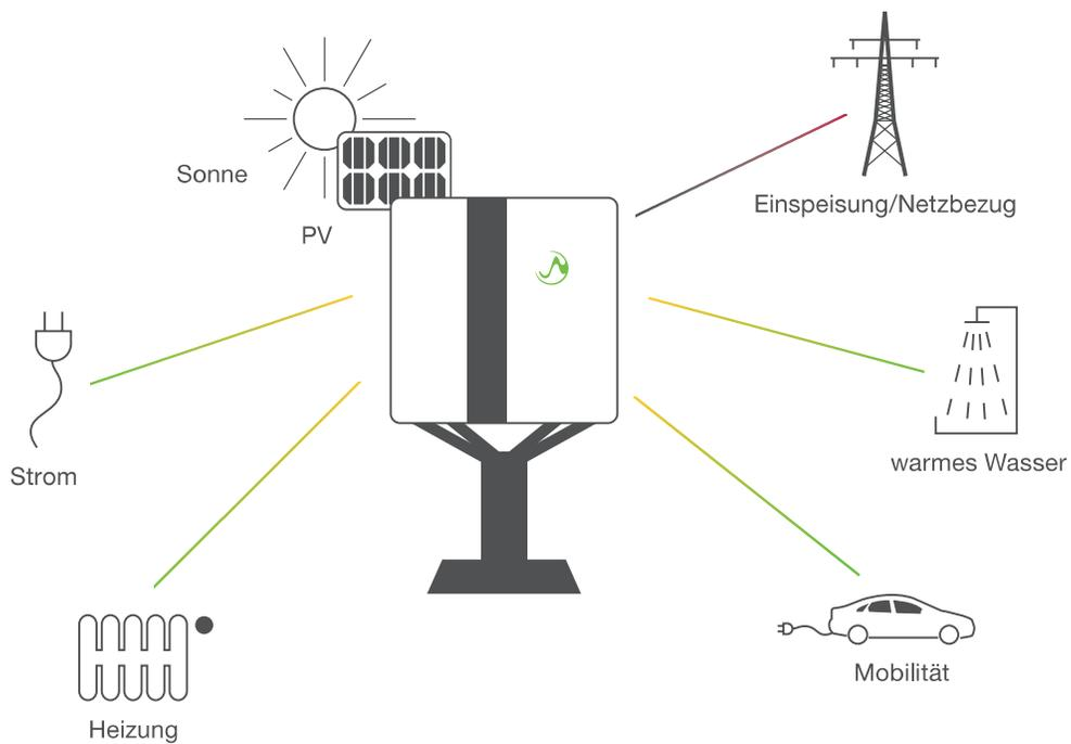
Das Hauskraftwerk ist das Herzstück dessen, was Sektorenkopplung genannt wird: Sauberer Solarstrom fliesst über das Hauskraftwerk vorrangig in Haushaltsgeräte, Wärmepumpen oder andere elektrische Heizgeräte und ins Elektroauto. Nur der Strom, der im Haus nicht verbraucht werden kann, geht ins öffentliche Netz.
