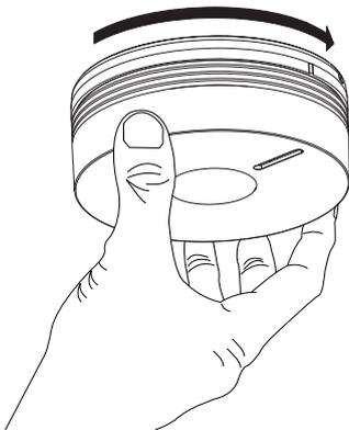
Melder im Uhrzeigersinn bis zur vollständigen Verriegelung drehen. Die gelbe LED blinkt 5 Sekunden lang und anschließend einmal alle 10 Sekunden, um die einwandfreie Funktion des Melders zu signalisieren.
