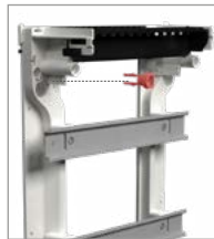
Clipsez l'adaptateur sur le châssis du coffret
