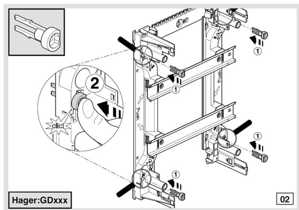
1. Clipsez l'adaptateur sur le châssis du coffret
